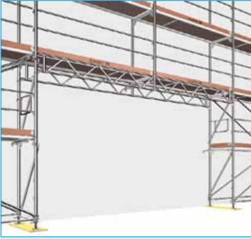
Örnek: Şimşek kafes taşıyıcı 5,14 m. Giydirilmiş iskele (özel çapraz konstrüksiyon)
